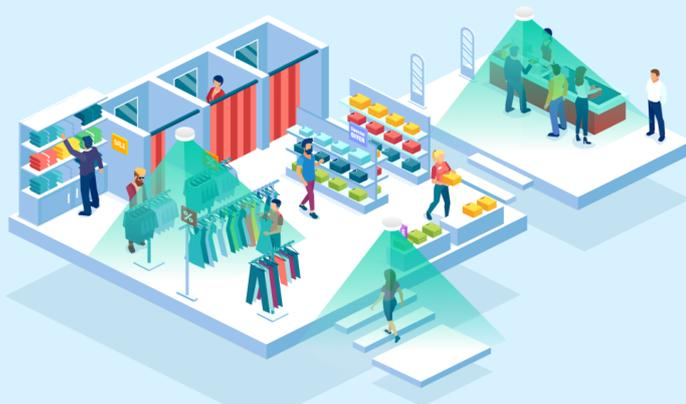
ピープルカウントすることでビジターを分析し、ビジネスで物理空間の効率を改善し、データに基いた意思決定を導き出し収益を増大させることが可能になります。Ultima AIセンサは、通行する人を検知し、来客者、滞留者をカウント、物理空間の来客フローをモニターします。来客者データはV-COUNT BIプラットフォームへ転送され、関係者は簡単にアクセスでき来客者データを閲覧、分析できます。最新のAI機械学習テクノロジーを用いることで、V-COUNTのピープルカウントソリューションは、GDPR（EU一般データ保護規格）コンプライアンスに完全に準拠し、99.9%の精度を提供します。
